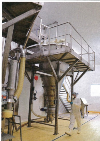
➤ Mélange. Le mélangeur Hosokawa Micron 2 t passe actuellement 6 t/j. En sortie, la vanne à segment sphérique ISEM se caractérise par un passage intégral et un logement sans rétention.
